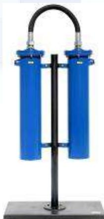
Фильтрационный модуль предназначен для тонкой очистки сжатого воздуха и различных газов от аэрозолей масла и влаги, а также от твердых частиц размером более 3 мкм. Обеспечиваемое остаточное содержание аэрозоля масла - менее 5 мг/м<sup>3</sup>. Используется в системах пневмоуправления и автоматики, пневмоприводе устройств и инструмента для окраски поверхностей распылением.
