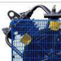
**Сетчатое ограждение** надежно изолирует ременную передачу поршневого компрессора во время его работы от обслуживающего персонала. Для удобного и безопасного открывания или снятия ограждения предусмотрены специальные замки. Ограждение составляет единое целое с конструкцией компрессора и соответствует требованиям технической эстетики.
